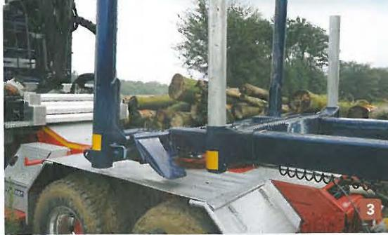
**Abb. 2:** Er löst die Rahmenverriegelung und zieht den Doppelteleskoparm der Ladebrücke nach vorn, um ihn am Lkw-Schemel zu arretieren.
