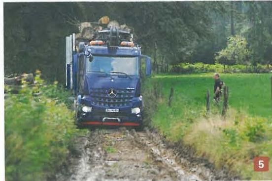
**Abb. 4:** Weil der schmale Fahrweg so schlammig ist, belädt Steinbach die Ladebrücke nur vorne.
