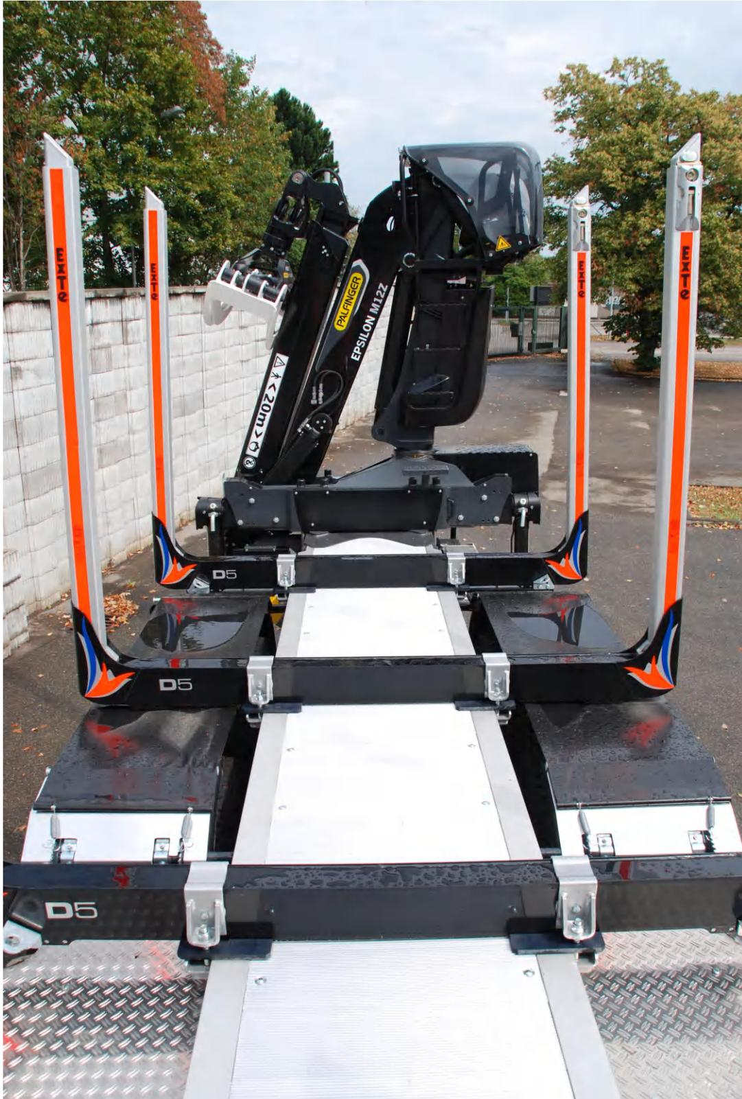
**Boden belegt mit geriffeltem Alu-Bodenprofil - versenkt montiert
